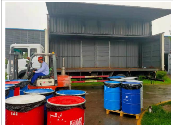
危废空桶的卸车及危废转移
